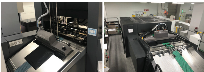
紙面昇温装置「SION」を印刷機のフィーダー部に取付けるだけ
